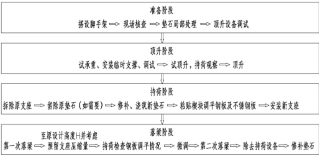
图 7-2 板式橡胶支座更换流程示意图
